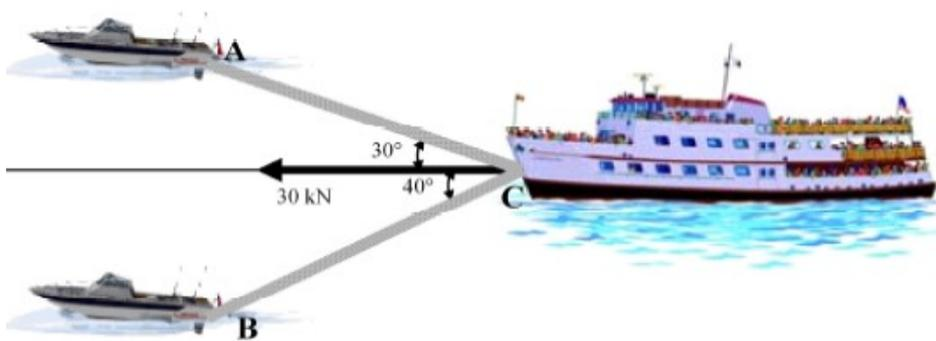
A partir da regra do paralelogramo construiremos um triângulo de vetores envolvendo as forças atuantes nos cabos **CA** e **CB** que queremos obter e a força resultante.
