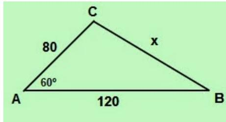
1) Uma construtora deseja construir um túnel para diminuir a distância entre dois bairros A e B. O topógrafo da empresa com o teodolito em C, mirou o ponto A e, a seguir, o ponto B, verificou no teodolito que o ângulo  $\hat{C}$  era  $60^\circ$ . Constatou também que as distâncias AC era 1km e CB igual 1,6 km. Determine o comprimento do túnel, sabendo que as distâncias dos pontos A e B ao morro são respectivamente 200m e 300m.
